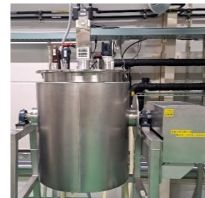
シアン化金カリウム製造設備
